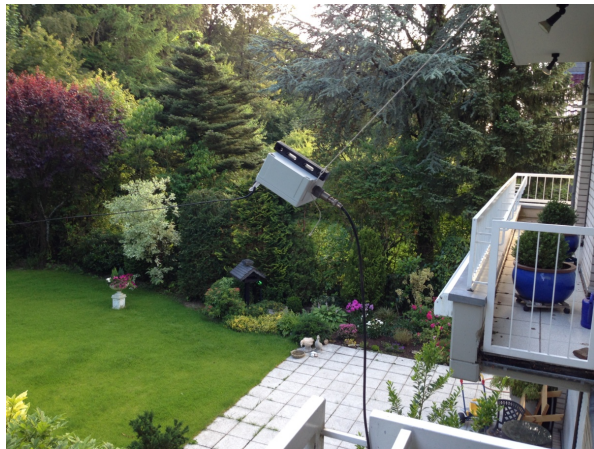
Transformator (Matchbox) hängend in der Luft montiert (günstig)
