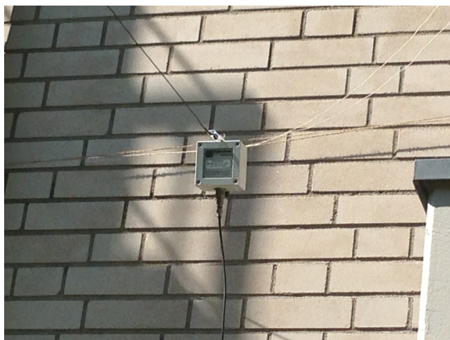
Positionierung vor der Hauswand, zwischen zwei Balkonen (optimale Stelle, geringstes SWR)
